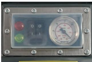
Alle elektrischen Bedienelemente und Warnanzeigen sind durch eine transparente Abdeckung geschützt, die gemäß den internationalen Normen EN IEC 60079-0:2018 Abschnitt 26.10, 26.8 und 26.9 geprüft wurde.
