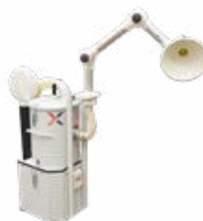
con cappa aspirante per estrazione diretta di polveri with suction arm for the direct extraction of dust and powders
