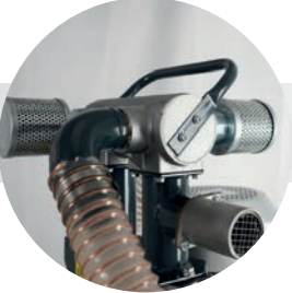
Flujo inverso para la descarga de líquidos alternativamente con la aspiración - Modelos "IF"
