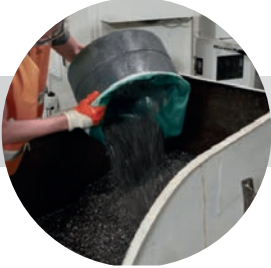
Descarga práctica de virutas desde la rejilla tamiz o desde el contenedor de recogida extraíble
