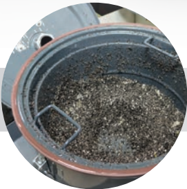
Rejilla tamiz para la separación de virutas y residuos metálicos de los aceites aspirados
