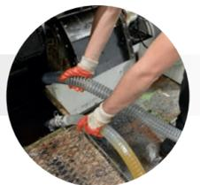
Pompa immersa per lo scarico dei liquidi simultaneo all'aspirazione Modelli "MPI"
