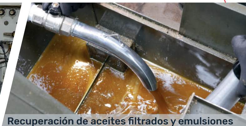
Aspiración y separación de aceite y virutas
