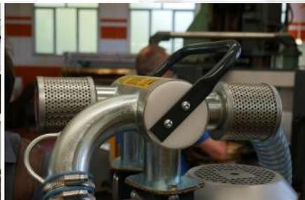
**Inversion de flux** pour le déchargement des liquides alterné à l'aspiration Modèles "IF"
