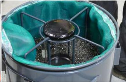
**Filtre PPL 300/100** micron pour une filtration majeure des copeaux plus fines
