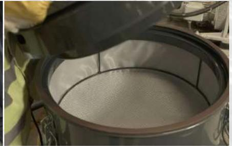
**Filtre 3D Superweb** pour protéger le moteur des brouillards d'huile
