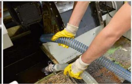
**Bomba sumergida** para succión y descarga simultáneas Modelos "MPI"
