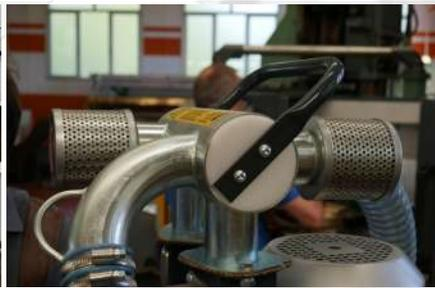
**Inversión de flujo** para descarga alterna de líquidos Modelos "IF"
