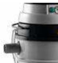
Valvola di sovrappressione installata per la **massima sicurezza**
