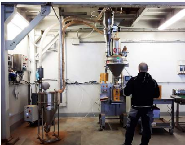
Caricamento di una confezionatrice Packaging machine load
