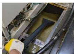
Aspirador de **fangos** y **lodos** del fondo del tanque
