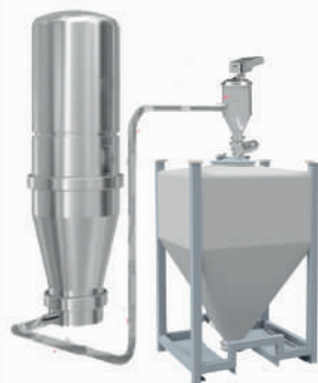
Lecho fluido a contenedor Décharge du lit fluide à conteneur
