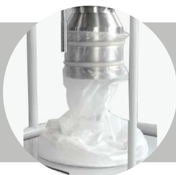
Sistema di raccolta polveri in sacchi di contenimento crimpabili monouso con rimozione e sostituzione sicura.
