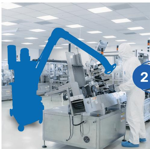
Depolveratori con braccio aspirante per evitare la dispersione di polveri nell'ambiente e l'esposizione degli operatori.
