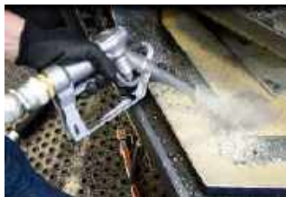
Sistema di scarico liquidi ad inversione di flusso (100 lt/min) Flux inversion liquids discharge system (100lt/min)
