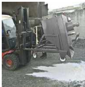
Pre-Separatori mobili, ribaltabili di grande capacità Tilting pre-separators, high capacity (400 - 600 Lt)
