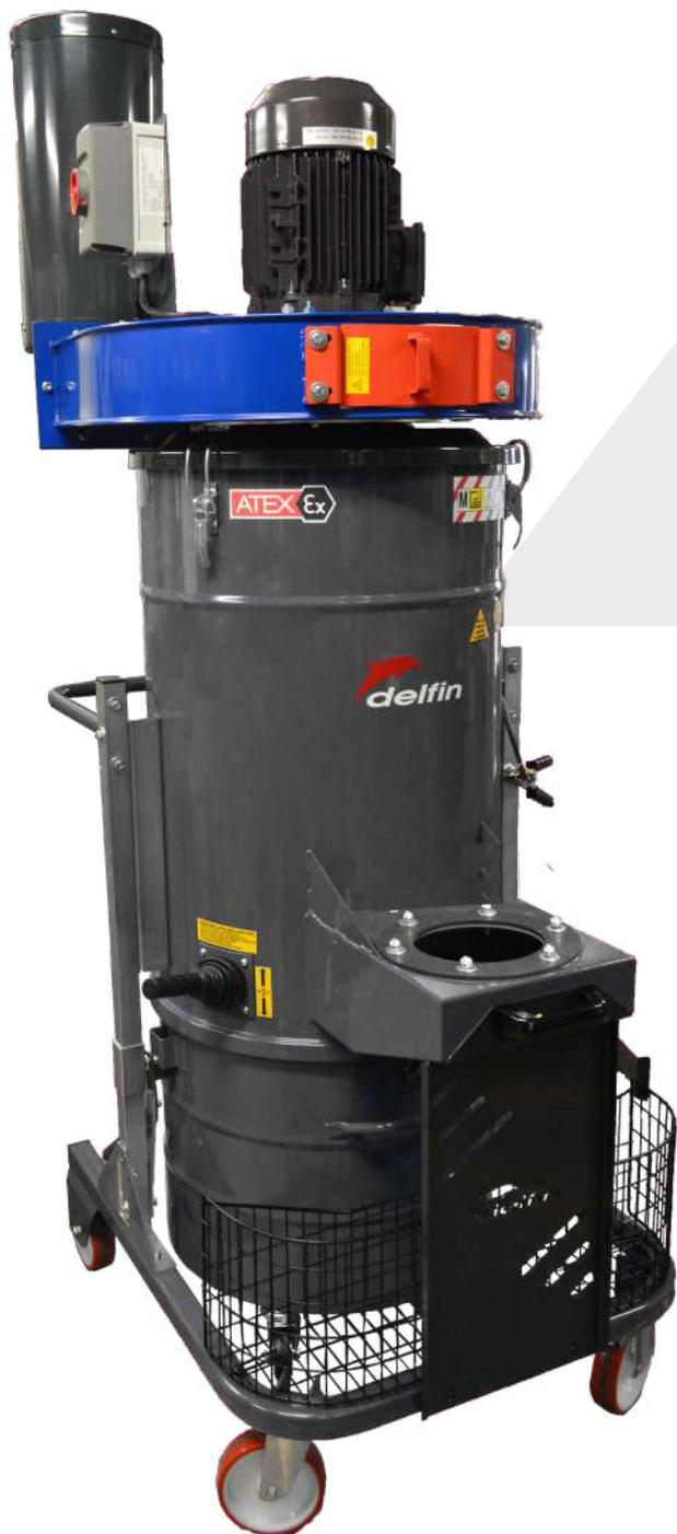
Los colectores de polvo son productos caracterizados por una muy alta caudal de aire. La función principal de un colector de polvo industrial es aspirar el polvo en suspensión para asegurar la mejor salud aérea dentro del área de trabajo.
