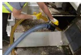
**Aspiración y descarga** simultáneas gracias a la bomba sumergida
