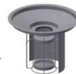
**Indicador de nivel y flotador** con parada mecánica cuando el contenedor está lleno
