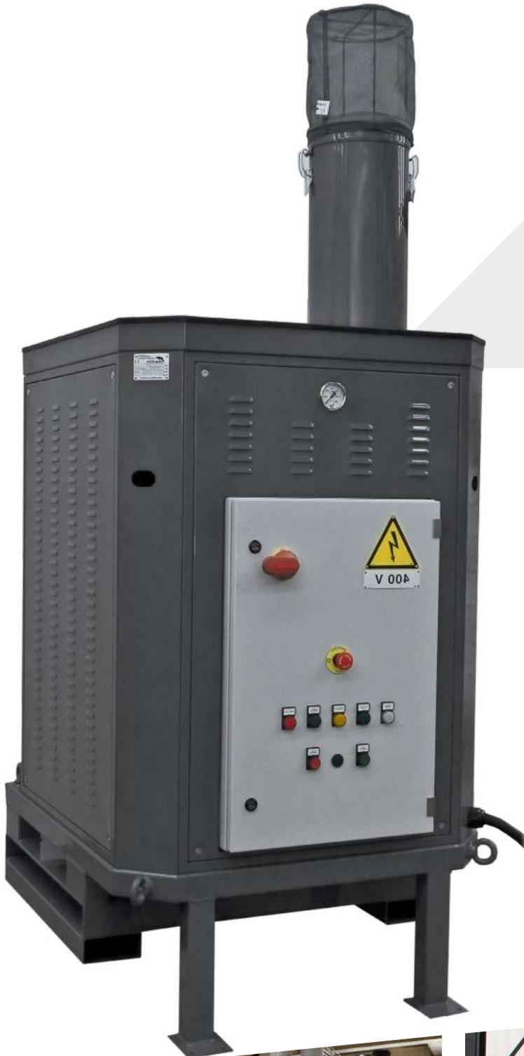
Los sistemas de aspiración centralizada Delfin permiten de aspirar materiales incluso a grandes distancias, o en varios lugares simultáneamente, según la potencia y las características de la unidad de aspiración y la condiciones de trabajo específicas.
