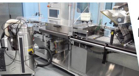
Aspira los residuos del producto directamente en la línea de producción durante el proceso de envasado Flow pack.
