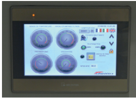
BEDIENFELD MIT HMI-DISPLAY AUF DER DHV-ANLAGE
